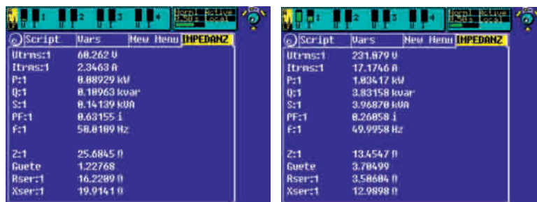
Anwenderdefiniertes Impedanz-Menü des Leistungsmessgerätes LMG500.
